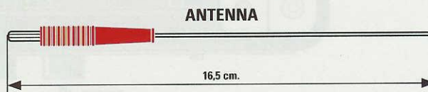
Fig.25 L'antenna trasmittente si ottiene fissando all'interno di una banana uno spezzone di filo di rame lungo 16,5 cm.
